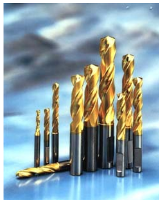
Figur 1. Titannitridytan på borrar och andra verktyg ger inte bara en fin finish utan ökar också borrharnas slitstyrka avsevärt trots att lagret bara är ett par mikrometer tjockt.
